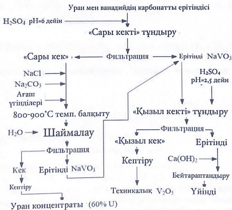
1.1-сурет - Карбонатты ерітінділерден уран мен ванадийді бөліп алу және бөлудің технологиялық схемасы
